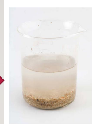
Figuur 5 Die stowwe in die vuil water sak af
