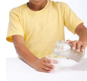
Figuur 11 Skei 'n mengsel van sand en water deur dekantering.
