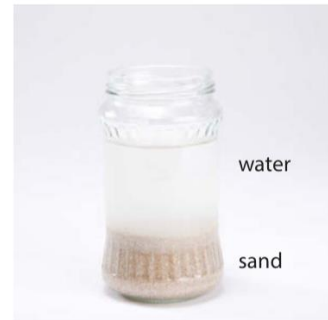
Figuur 10 Mengsel van sand en water word geskei deur afsakking
