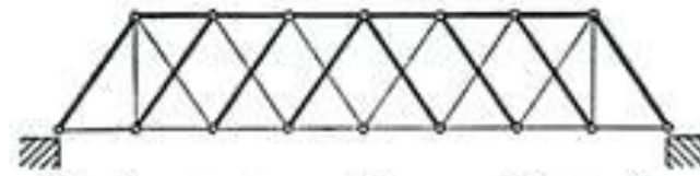
(d) QUADRANGULAR THROUGH WARREN TRUSS
